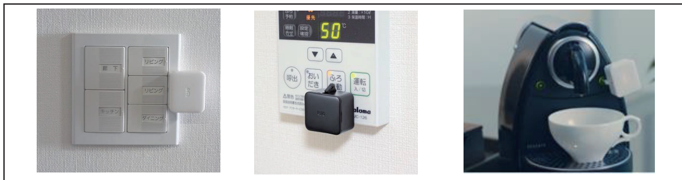
図3 スイッチボットの設置例
